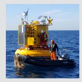
Connaître dans le détail les vitesses du vent et les courants marins sur la zone du projet est essentiel pour les équipes techniques. Pour effectuer ce recueil, un outil de mesure particulièrement innovant a été déployé en mer : un lidar. Sa particularité ? Il mesure les données par laser.
